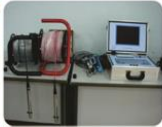
Ultrasonic instrument for testing uncased pile defect Máy siêu âm kiểm tra khuyết tật cọc nhồi
