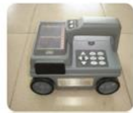
Rebar and pipe detection instrument Máy dò tìm thép và các ống kỹ thuật trong bê tông
